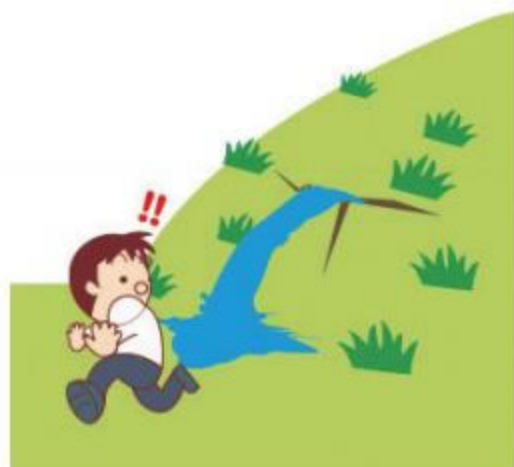
亀裂・水の吹き出し
